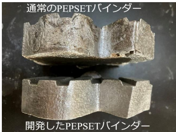
従来のPEP SET 発泡ポリスチレンが収縮、侵食されている
