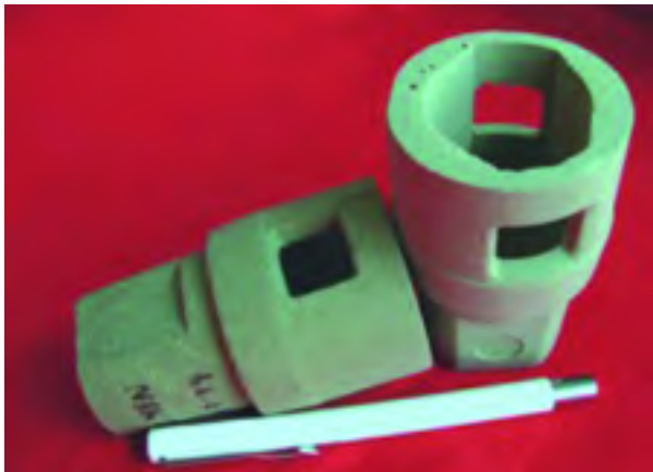
Figura 2: Macho Final 50% Arena + 50% Aditivo, Sin Pintar.
