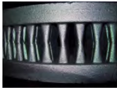
Disco de Freno de Ferrocarril de 130 kg
