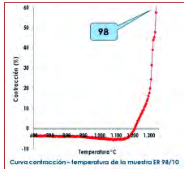
Figura 7: Curva de Contracción de la muestra 77 con 6% de Carbonato de Litio (muestra 98).
