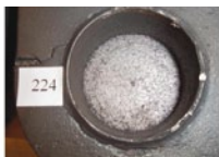
ungeschlichtet 47,5% C-60 + 47,5% Chromit +5% ESA 2011-Additiv, 1,1% Cold-Box-Binder
