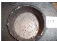
ungeschlichtet 71,25% C-60 + 23,5% Chromit +5% ISOSEAL™ 2011 1,2% Cold-Box 419/619
