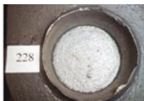
geschlichtet 47,5% C-60 + 47,5% Chromit +5% neues ESA 2011-Additiv, 1,1% Cold-Box-Binder
