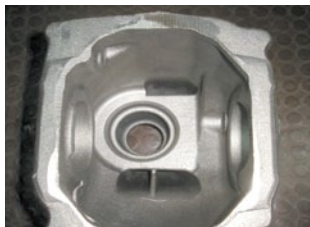
Fig. 2: Carcasa diferencial: comparación entre un macho pintado, sin aditivos (imagen izquierda) y el nuevo aditivo ESA 2011, sin pintar (imagen derecha).
