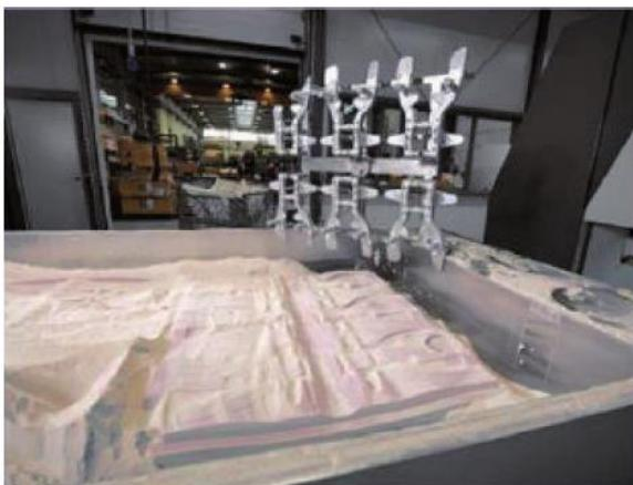
図4 NOVASET 中子仕上げにかかる労力はフラン樹脂中子よりもずっと少ない。(写真: Grunewald GmbH&Co.KG)
