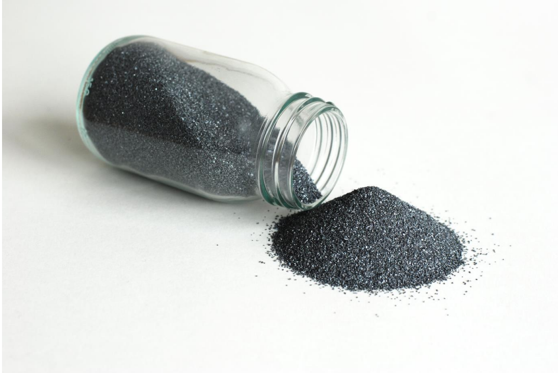
Fig. 1: Inoculante multifuncional para produzir tubos fundidos centrifugados
