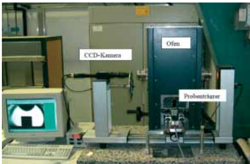
Bild 7. Messmethode zur Ermittlung des Benetzungswinkels mit Hilfe des Erhitzungsmikroskops
