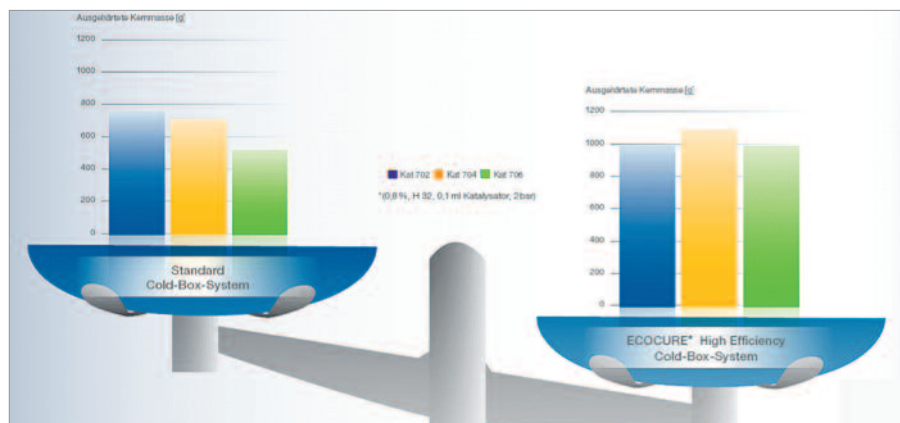
Bild 10. Vorteil Amineinsparung: Die neuen HE-Systeme sind deutlich reaktiver in Verbindung mit allen gebräuchlichen Katalysatortypen
