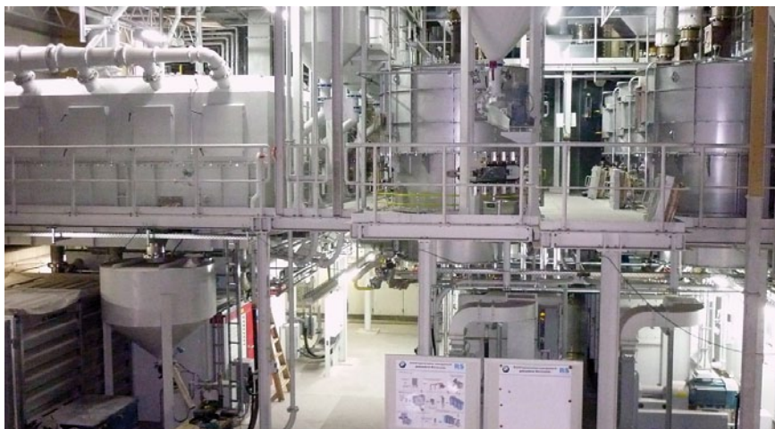
Bild 12: Serienanlage zur Regeneration anorganischer Gießereialsande bei der BMW Group, Leichtmetallgießerei Landshut.
