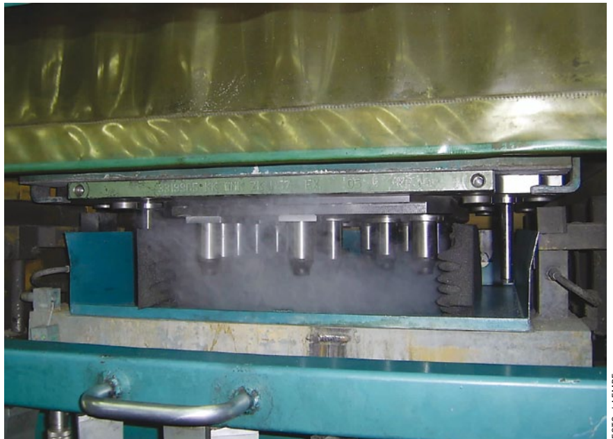
Bild 4: Verhindert das Austrocknen an den Düsen – Ultraschallvernebler im Bereich der Schussplatte.
