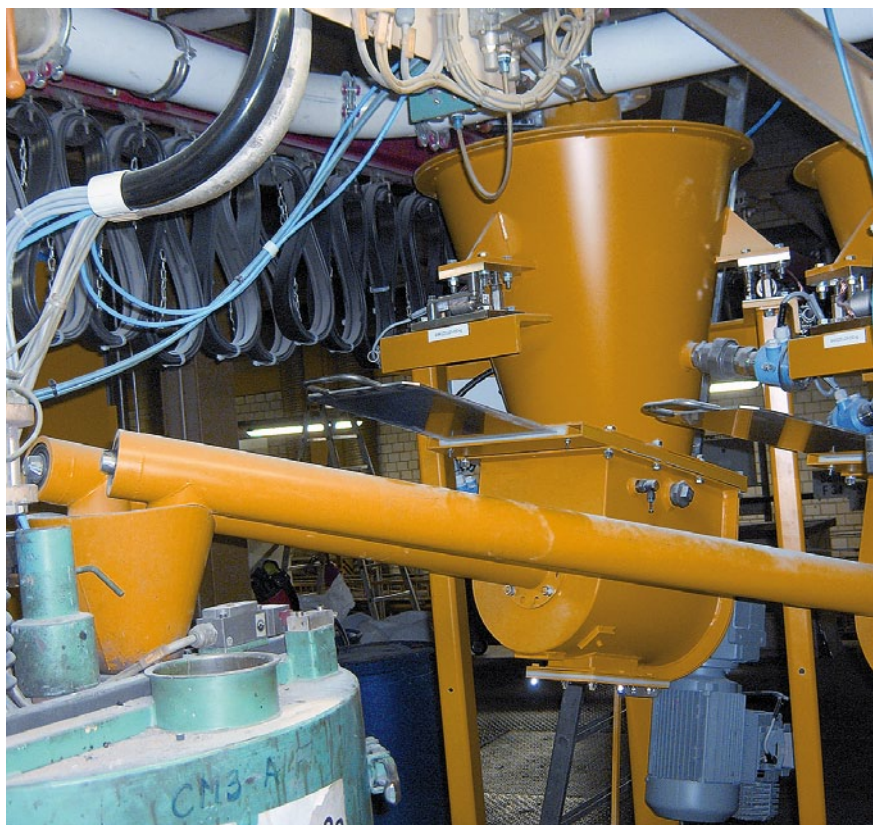
Bild 7: Schneckendosierer mit elektronischer Wägezelle.
