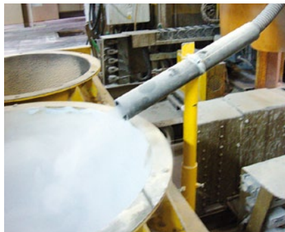
Bild 5: Benetzung der Sandmischung am Verfahrenswagen.
