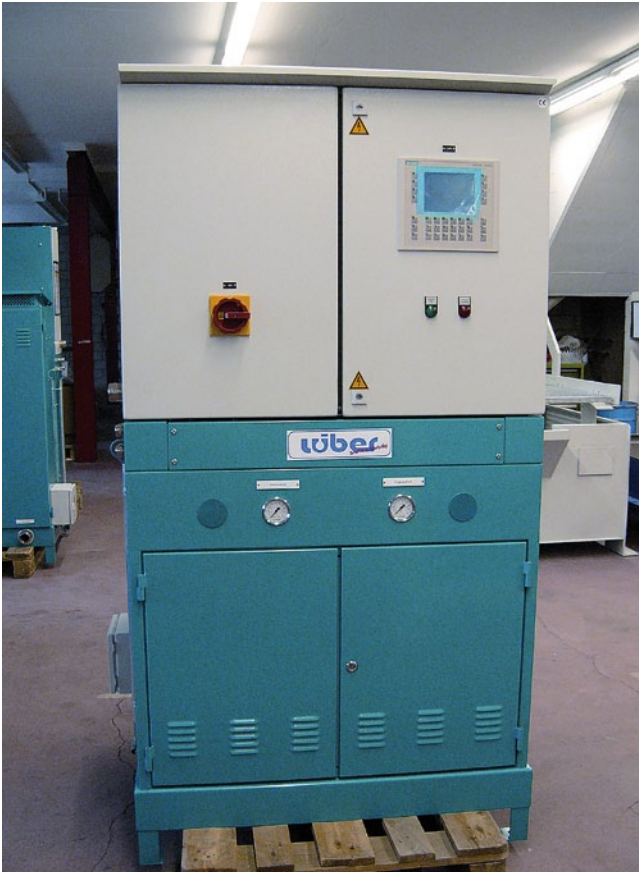
Bild 10: Leistungsstarke Begasungseinheit zur Erzeugung der Heißluft.
