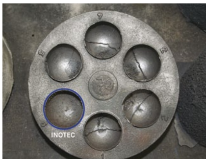
Bild 13: Domkernabguss in GJL (Gießtemperatur: 1420 °C) – die mit Inotec hergestellten Abgüsse zeigen im Vergleich zu den im Cold-Box-Verfahren hergestellten keine Ansätze von Blattrippen.
