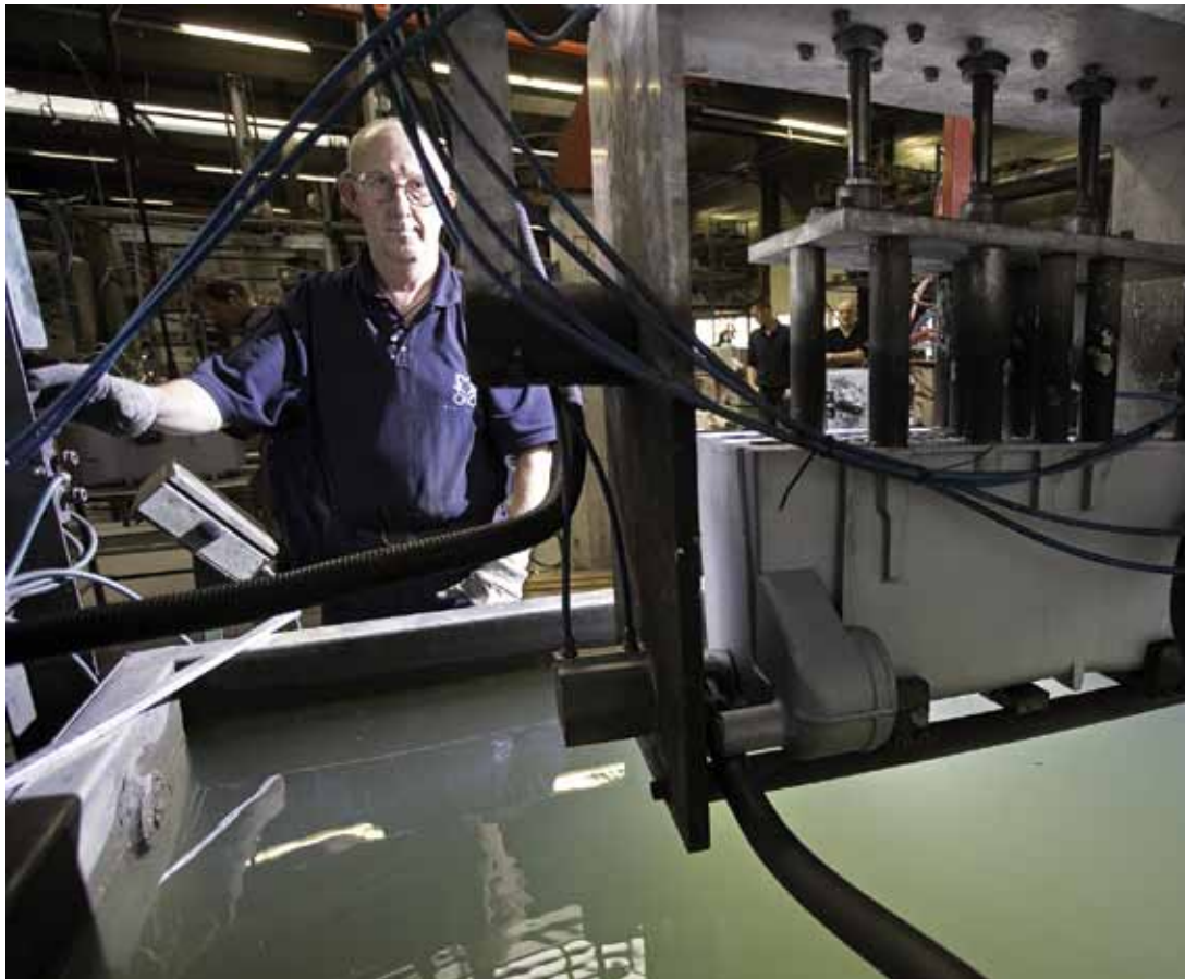
Bild 3: Bei der Dichtigkeitsprüfung werden die Gussstücke auf mögliche Gasfehler und Schrumpfporositäten geprüft. Speziell in der Produktion der Heizkessel, bei der man auf sehr filigrane Kerne setzt, konnte mit Ecocure SL der Ausstoß aufgrund von Gasfehlern um über 5 % reduziert werden.
