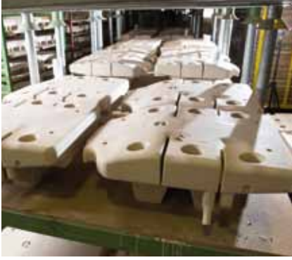
Bild 5: Die Zugabemenge von Teil 2 kann mit dem neuen Ecocure™ SL-System um mehr als 20 % reduziert werden. Dosiermengen des Wettbewerbsproduktes: Teil 1 0,52 % und Teil 2 0,52 %; Dosiermengen des Ecocure™ SL-Systems: Teil 1 0,53 % und Teil 2 0,40 %.
