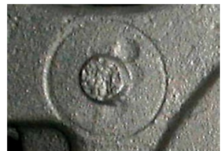
Bild 4: Abdruck des Brechkerns auf einer Gießform, die aus der Hohlform kommt.
