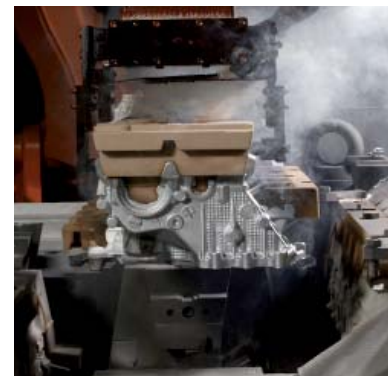
Bild 1: Rauchentwicklung beim Abgießen eines Zylinderkopfes mit organisch gebundenen Sandkernen
