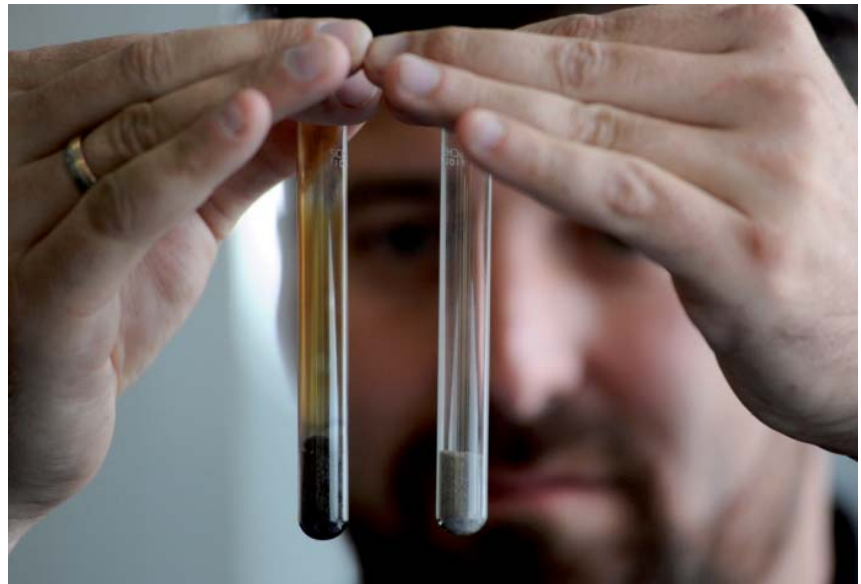
Bild 2: Kondensatbildung organischer (links) und anorganischer (rechts) Kernsandmischungen beim Erhitzen.
