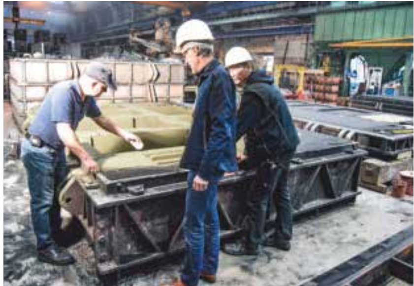
Bild 2: Produktionsleiter Stefan Braun, Ulf Schmidtgen, Segmentleiter der Koenig & Bauer Gießerei GmbH und Ulf Knobloch, ASK Chemicals GmbH, beim Messen der Nassschichtstärke (v.l.n.r.).
