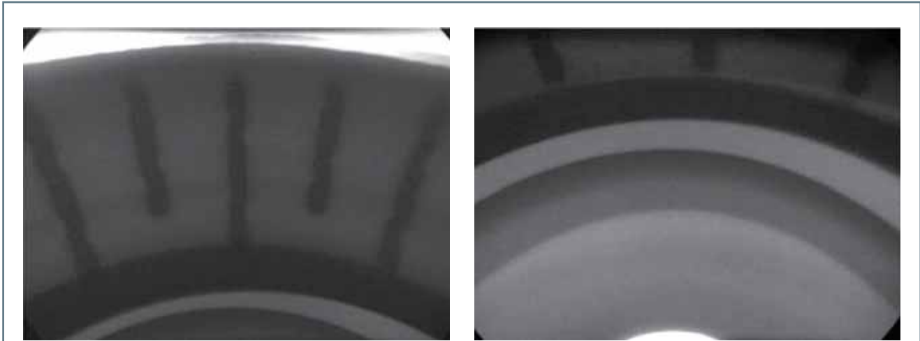
Bild 11: Röntgenaufnahmen der Versuchsbremsscheibe.
