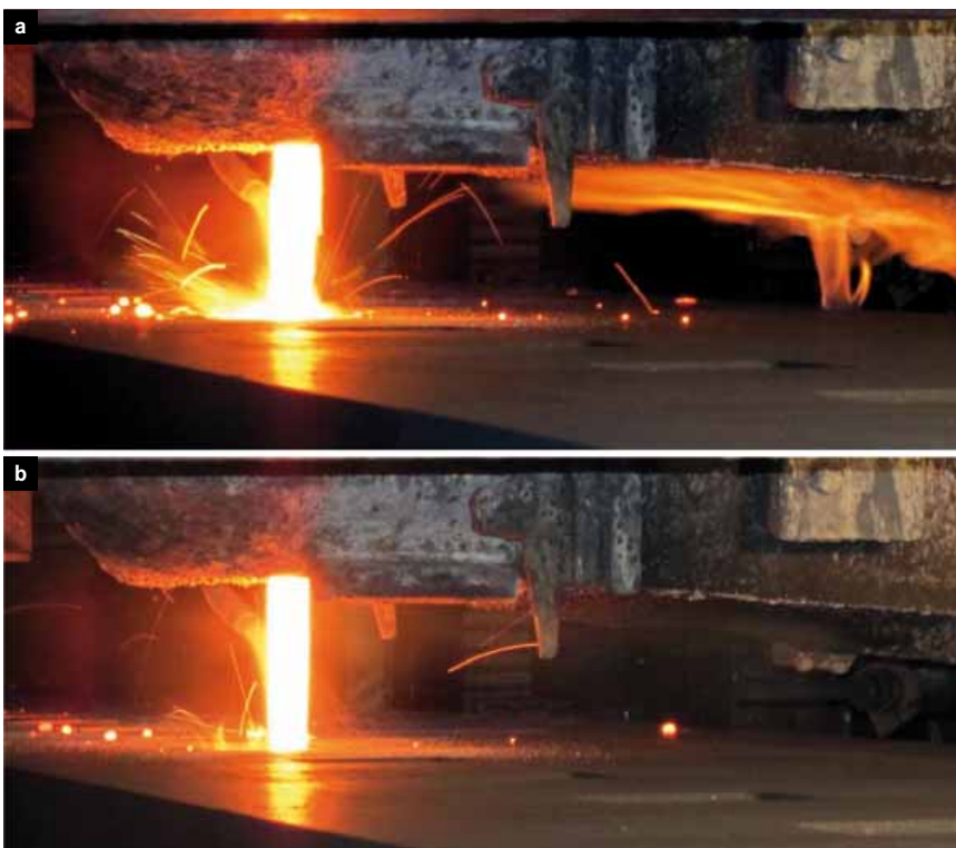
Bild 5: Abguss der Sandkerne: a) PUR-Cold-Box, b) Inotec.
