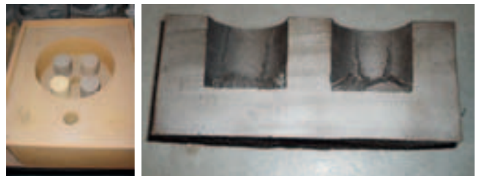
Abb. 3: Kerne und Form des 2x2-Tests (links) und durchtrenntes Gussteil (rechts) mit dem Blattrippendefekt
