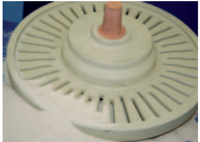
Abb. 5: MIRATEC BD verhindert Blattrippen-Defekte an der Trennlinie
