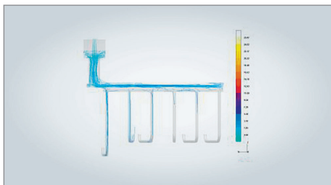
Bild 7: Beginn des Gießens der Filterbank
