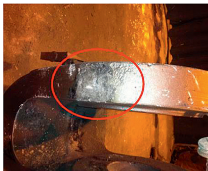
Bild 27: Oberflächenfehler am Gussstück
