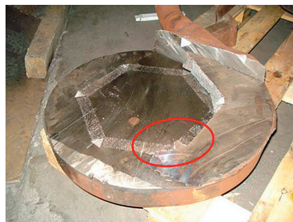
Bild 15: Fehlendes Eckstück (aufgeschnittenes Filterkarussell nach dem Guss)
