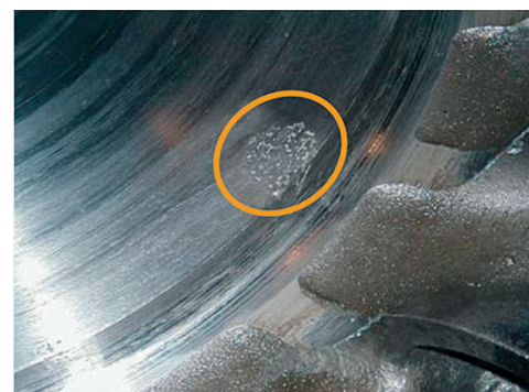
Bild 12: Filterteile im Gussstück: sichtbar nach Bearbeitung
