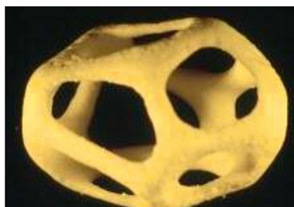
Bild 2: Typische Filterzelle in Dodekaeder-Form
