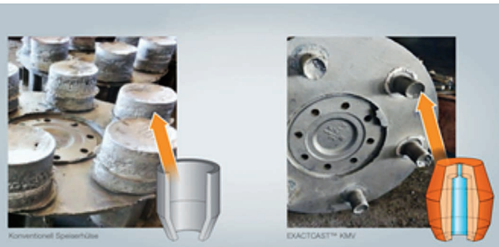
Bild 5: Mehr Güsse pro Pflanze: Ein wesentlicher Vorteil des geringeren Schmelzebedarfs und des verbesserten Ausbringens der kleinen Speiser ist, dass damit pro Ladung Flüssigmetall mehr oder größere Teile gegossen werden können. Diese erhöhte Gießkapazität kann sogar neue Auftragsfelder eröffnen.
