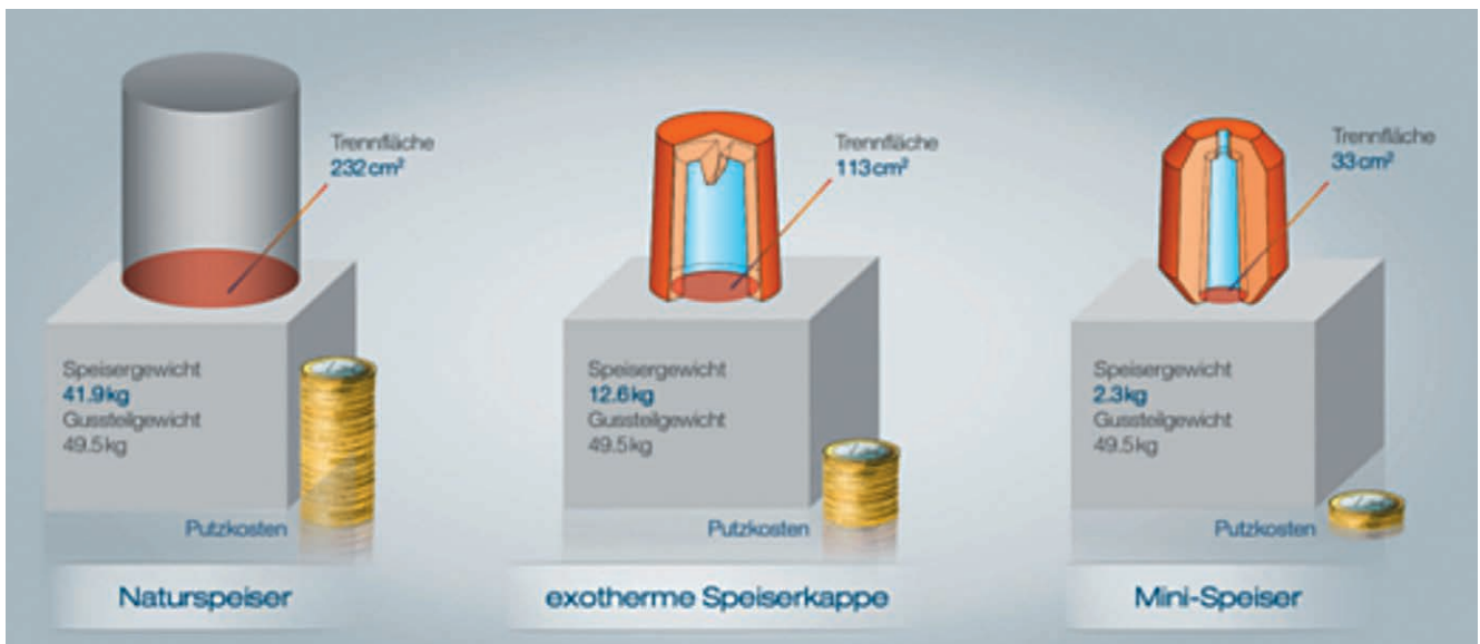
Bild 4: Vergleich konventioneller, exothermischer und Mini-Speiser: Durch ihr verringertes Volumen fallen auch das Gewicht und die Kontaktfläche der Minispeiser deutlich geringer aus, was die Kosten für die Nachbearbeitung des Gussteils verringert und die Produktionseffizienz insgesamt erhöht.
