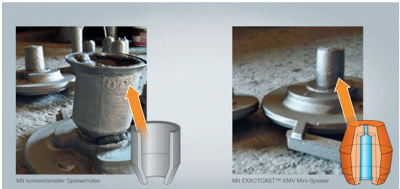
Bild 1: Vergleich normaler und Mini-Speiser: Speiser sind im Sandguss unersetzlich, benötigen jedoch in der Regel ineffizient hohe Schmelzevolumina, um ihren Zweck zu erfüllen. Mini-Speiser aus exothermen, selbst heizenden Mischungen können hier helfen, Material- und Putzaufwand zu reduzieren.
