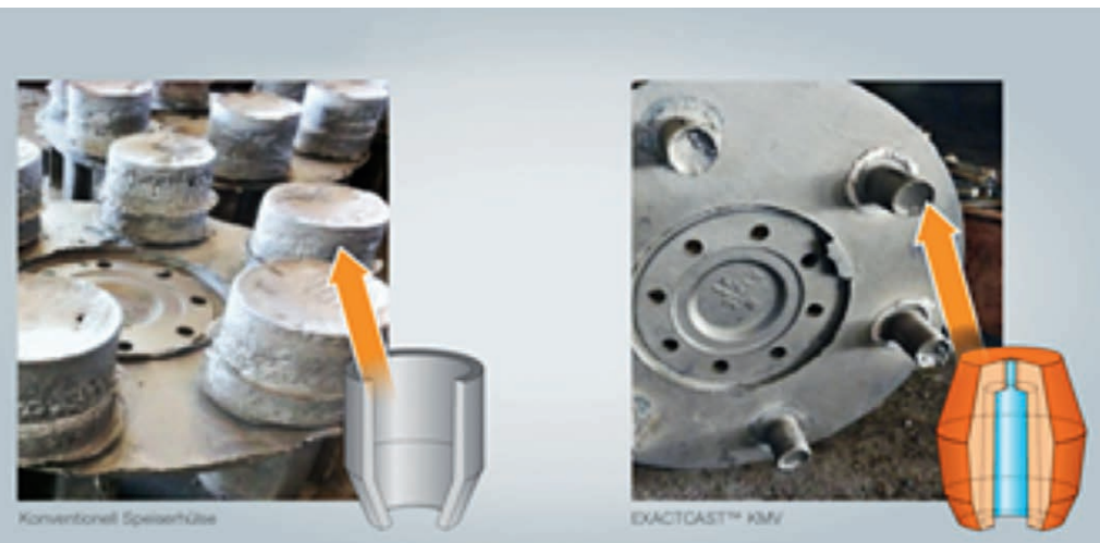
Bild 5: Mehr Güsse pro Pfanne: Ein wesentlicher Vorteil des geringeren Schmelzebedarfs und des verbesserten Ausbringens der kleinen Speiser ist, dass damit pro Ladung Flüssigmetall mehr oder größere Teile gegossen werden können. Diese erhöhte Gießkapazität kann sogar neue Auftragsfelder eröffnen.
