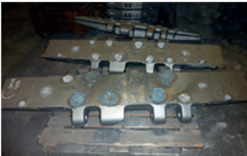
Bild 6: Das Abtrennen und Putzen bedeutet bei der kleinen Ansatzfläche kaum Aufwand. Auf Wunsch können die KMV-Mini-Speiser aber auch mit Brechkanten oder Tüllen ausgestattet werden.
