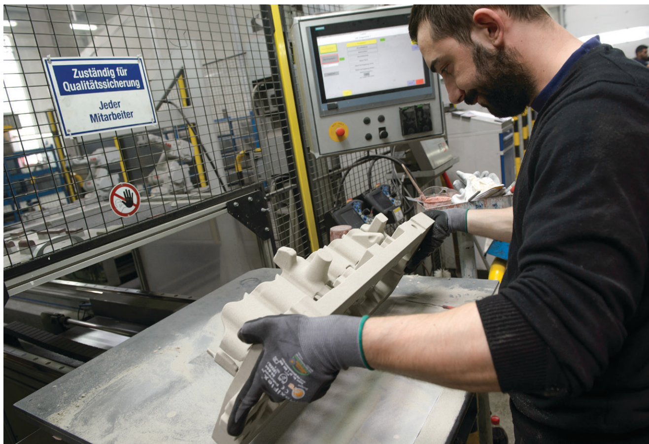
Ein ASK-Mitarbeiter prüft einen anorganischen Kern auf Fehlstellen
