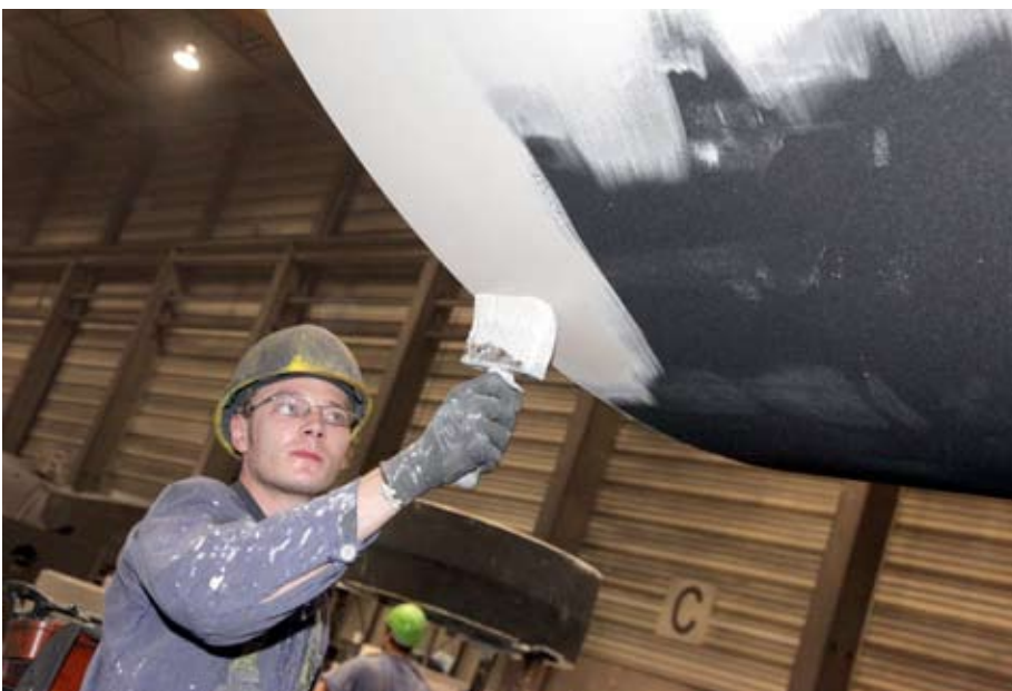
Qualitätsbewußtsein: Sorgfältig wird die Spezialschichte auf die Riesenkerne aufgebracht.
