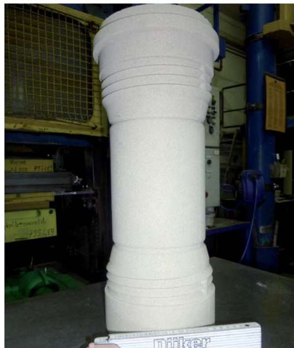
Fig. 6 a: Düker produce la mayor parte de su gama de machos con el nuevo aglomerante ECOCURE BLUE.
