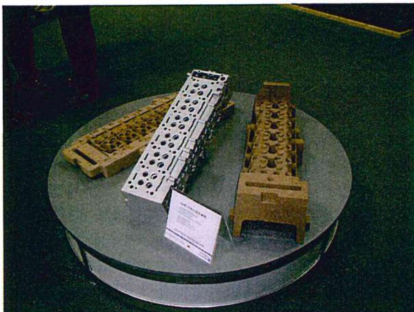
コールドボックス法で製造した品質の良いアルミニウムシリンダーヘッド
