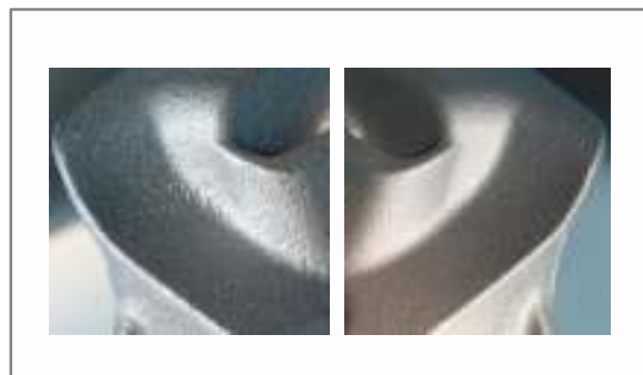
図 7 鑄肌の比較-バインダーの差: 従来 (フラン樹脂を使用)、新しい (PEP SET バインダーを使用)
