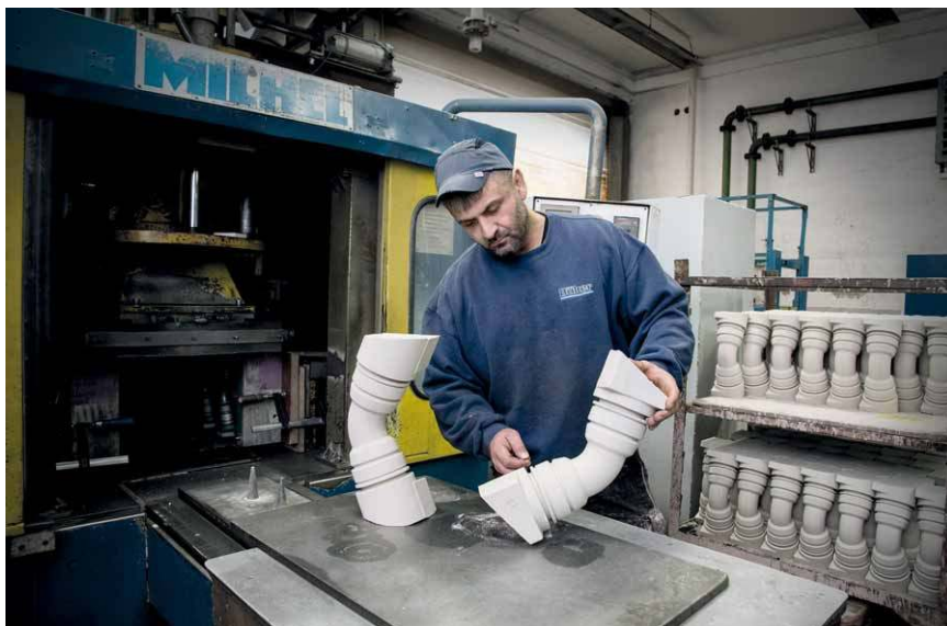
図4: Düker社は、新しいバインダーであるEcocure Blueを使用して、中子のほとんどを造型しています
