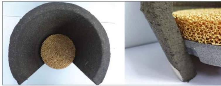
図4 ライザー中のサポートリング付きフィルター（湯が迂回する可能性がある）
