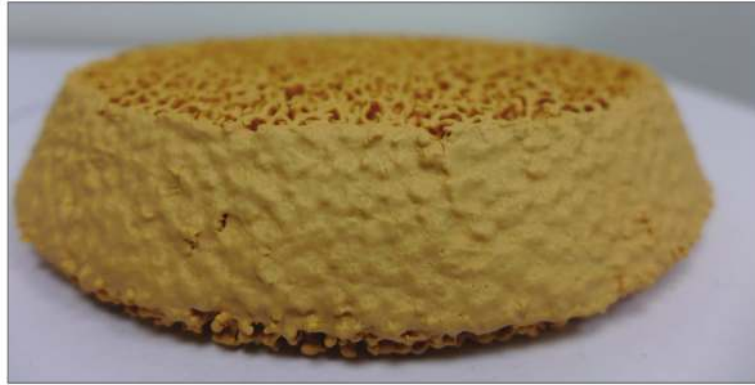
図5 円錐形フィルターは、全周端面保護も可能
