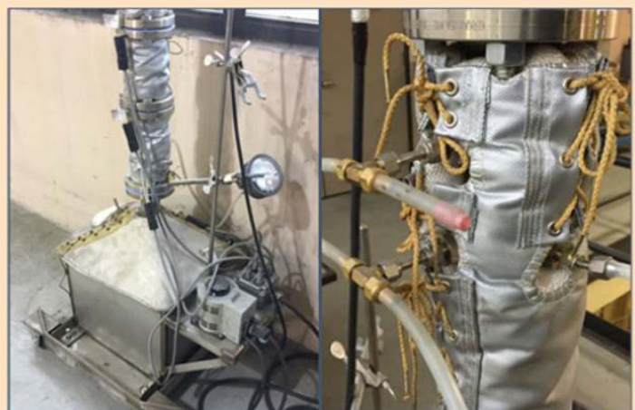
図4. フードスタック装置の外観とガス気流 サンプルポート
