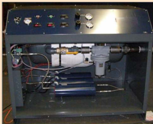
図 1 . SO 2 /N 2 ガス発生装置(A-E/SO 2 プロセス用)
