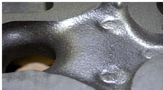
写真5: MIRATEC™ TS による鋳肌
