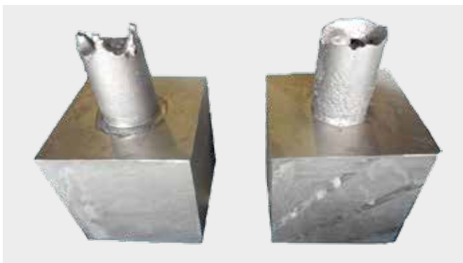
図3 試験片と押湯 (製品M=3.33cm)
