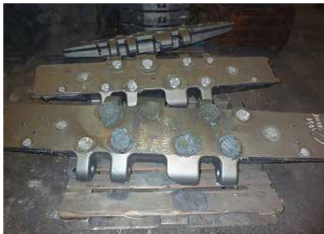
図14 歩留りが58%（写真下）から76%（同上）に改善し、さらに仕上げ時間の短縮も図られた（炭素鋼）
