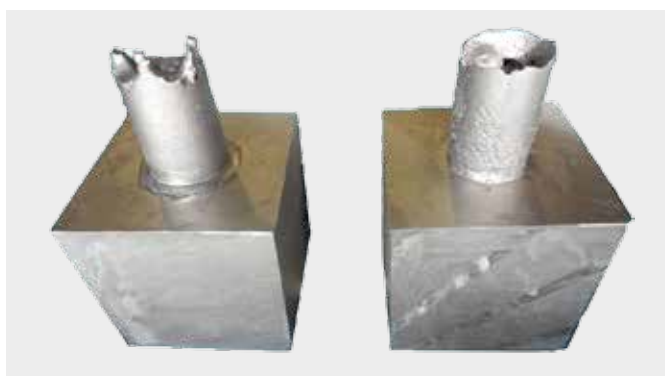
図3 試験片と押湯(製品M=3.33cm)
