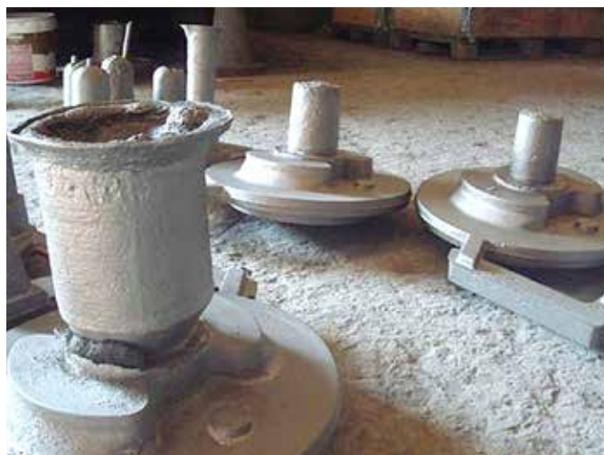
図13 歩留り最適化の例（ステンレス・スチール）
