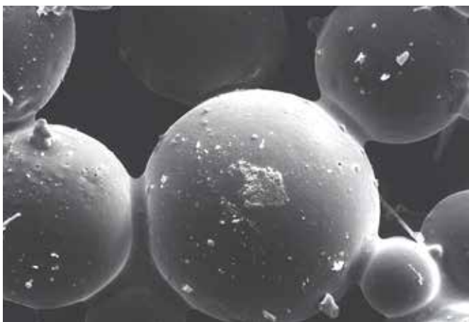
図7 マイクロスフィアの固着メカニズムの詳細
