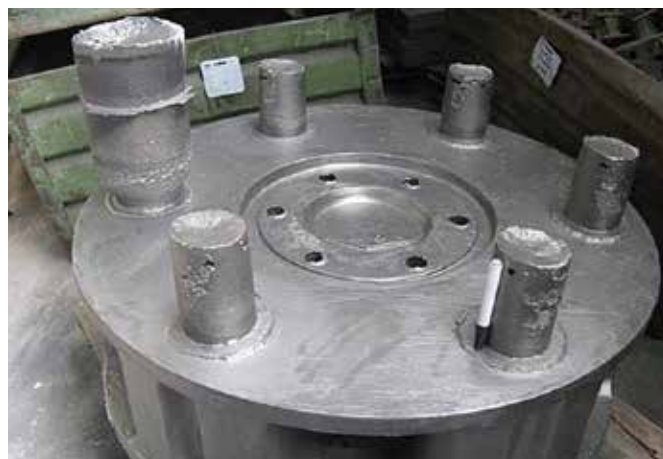
図11 マンガン鋼鋳鋼品：従来の押湯(最も左)とミニライザー(中央と右)の挙動
