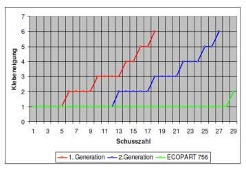
Bei Erreichen der Stufe 6 ist eine weitere Abprüfung unter Laborbedingungen nicht möglich.
